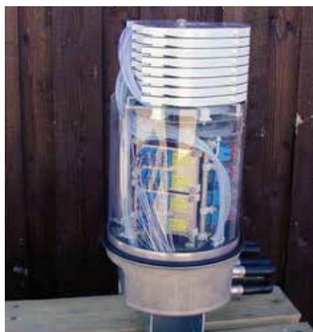
Undermark ODF med 96 SC kontakter.
