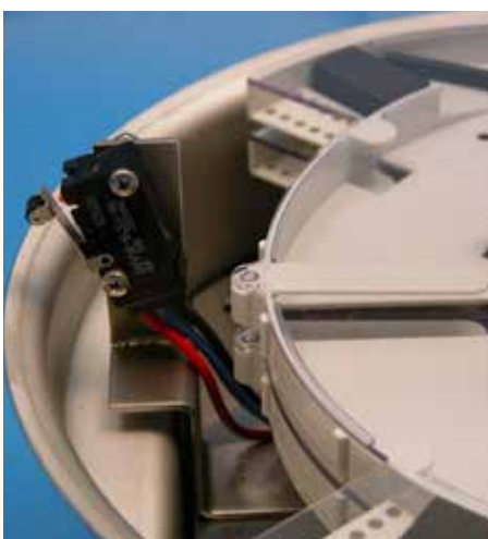
Microbrytare för indikering vid öppning av box.
