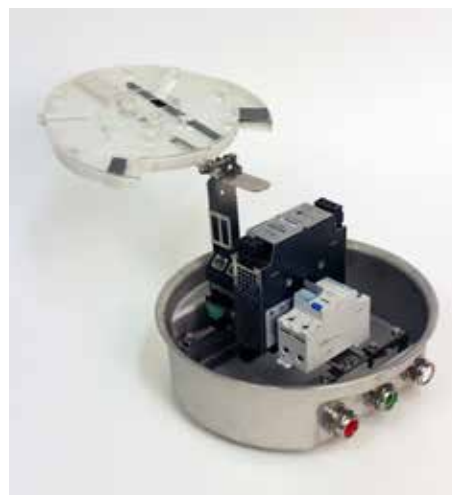
Aktiv utrustning installerad i T240.
